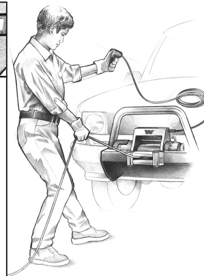
Étape 18 : ENROULEZ LE CÂBLE. La personne qui s'occupe du câble doit guider le câble à l'intérieur, ne pas le laisser glisser dans la main et contrôler le treuil en permanence.
